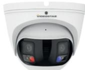
IP Camera 8 MP: 3840x2160. Ottica fissa 2,8 mm con visione a 180°. Supporta funzioni SMART. 2x LED array (Portata 25~30 m) +2x LED bianchi (Portata 10~15 m) +2x LED rosso/blu per Active Deterrence. Microfono e Speaker integrati. Slot per microSD card fino a 256 GB. Alimentazione 12 Vdc, PoE 802.3af, Grado di protezione IP67 e IK10. Housing metallico D99.
