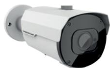
IP Camera 5 MP: 2592x1944. Ottica motorizzata 2,7~13,5 mm. Supporta funzioni SMART. 4x LED array (Portata 40~45 m). 1 Ingresso e 1 Uscita audio RCA, 1 Ingresso e 1 Uscita Allarme, Slot per microSD card fino a 256 GB. Alimentazione 12 Vdc, PoE 802.3af, Grado di protezione IP66. Housing metallico B50.
