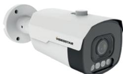
IP Camera 5 MP: 2880x1620. Ottica motorizzata 2,8~12 mm. Supporta funzioni SMART. 4x LED array (Portata 30~35 m) +4x LED bianchi (Portata 25~30 m). 1 Ingresso e 1 Uscita audio RCA, 1 Ingresso e 1 Uscita Allarme, Slot per microSD card fino a 256 GB. Alimentazione 12 Vdc, PoE 802.3af, Grado di protezione IP66. Housing metallico B50.
