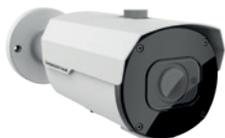
HD Camera 5 MP: 2592x1944. Ottica Varifocal manuale 2,8~12 mm. Supporta formati video TVI, AHD, CVI e CVBS. 1 uscita video BNC. 4x LED array (Portata 30~35 m). Grado di protezione IP66. Housing metallico B50.
