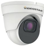
HD Camera 2 MP: 1920x1080. Ottica motorizzata 2,7~13,5 mm. Supporta formati video TVI, AHD, CVI e CVBS. 1 uscita video BNC. 4x LED array (Portata 30~35 m). Grado di protezione IP66. Housing metallico D99.
