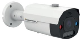
IP Camera 5 MP: 2880x1620. Ottica motorizzata 2,8~12 mm. Supporta funzioni SMART. 4x LED array (Portata 30~35 m) +4x LED bianchi (Portata 25~30 m) +2x LED rosso/blu per Active Deterrence. Microfono e Speaker integrati, Slot per microSD card fino a 256 GB. Alimentazione 12 Vdc, PoE 802.3af, Grado di protezione IP66. Housing metallico B50.
