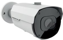
IP Camera 5 MP: 2592x1944. Ottica motorizzata 2,7~13,5 mm. Supporta funzioni SMART. 4x LED array (Portata 40~45 m). 1 Ingresso e 1 Uscita audio RCA, 1 Ingresso e 1 Uscita Allarme, Slot per microSD card fino a 256 GB. Alimentazione 12 Vdc, PoE 802.3af, Grado di protezione IP66. Housing metallico B50.
