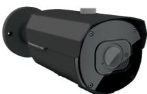
IP Camera 5 MP: 2592x1944. Ottica motorizzata 2,7~13,5 mm. 4x LED array (Portata 40~45 m). 1 Ingresso e 1 Uscita audio RCA, 1 Ingresso e 1 Uscita Allarme, Slot per microSD card fino a 256 GB. Alimentazione 12 Vdc, PoE 802.3af, Grado di protezione IP67. Housing metallico B50.
