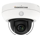
IP Camera 4 MP: 2560x1440. Zoom ottico 4x (2,8~12 mm). Supporta funzioni SMART. 4x LED array (Portata 15~20 m) Microfono e Speaker integrati. Slot per microSD card fino a 256 GB. Alimentazione 12 Vdc, PoE 802.3af, Grado di protezione IP66 e IK10. Housing metallico 4IPSD4.
