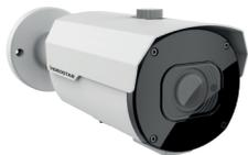
HD Camera 5 MP: 2592x1944. Ottica motorizzata 2,7~13,5 mm. Supporta formati video TVI, AHD, CVI e CVBS. 1 uscita video BNC. 4x LED array (Portata 30~35 m). Grado di protezione IP66. Housing metallico B50.
