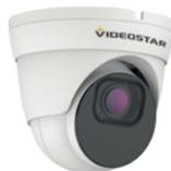
HD Camera 5 MP: 2592x1944. Ottica varifocal manuale 2,8~12 mm. Supporta formati video TVI, AHD, CVI e CVBS. 1 uscita video BNC. 4x LED array (Portata 30~35 m). Grado di protezione IP66. Housing metallico D99.
