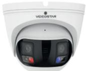
IP Camera 8 MP: 3840x2160. Ottica fissa 2,8 mm con visione a 180°. Supporta funzioni SMART. 2x LED array (Portata 25~30 m) +2x LED bianchi (Portata 10~15 m) +2x LED rosso/blu per Active Deterrence. Microfono e Speaker integrati. Slot per microSD card fino a 256 GB. Alimentazione 12 Vdc, PoE 802.3af, Grado di protezione IP67. Housing metallico D99.
