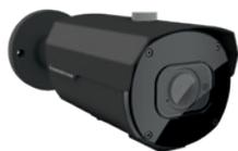
HD Camera 2 MP: 1920x1080. Ottica Varifocal manuale 2,8~12 mm. Supporta formati video TVI, AHD, CVI e CVBS. 1 uscita video BNC. 4x LED array (Portata 30~35 m). Grado di protezione IP66. Housing metallico B50.
