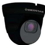
IP Camera 5 MP: 2592x1944. Ottica varifocal manuale 2,7~13,5 mm. 4x LED array (Portata 40~45 m), 1 Ingresso e 1 Uscita audio RCA, Slot per microSD card fino a 256 GB. Alimentazione 12 Vdc, PoE 802.3af, Grado di protezione IP67. Housing metallico D99.
