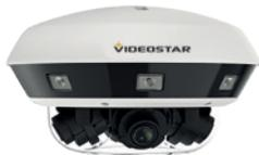
IP Camera 8 MP: 3840x2160. 4x Ottiche Motorizzate 2,8~12 mm. Supporta funzioni SMART. 4x LED array (Portata 25~30 m) +4x LED bianchi (Portata 10~15 m). 1 Ingresso e 1 Uscita audio. 2 Ingressi e 2 Uscite allarme. Slot per microSD card fino a 256 GB. Alimentazione 12 Vdc, 24Vac, Hi PoE 802.3af/at/bt, Grado di protezione IP67 e IK10. Housing metallico.
