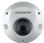
IP Camera 5 MP: 2880x1620. Ottica fissa da 2,8 mm. Supporta funzioni SMART. 2x IR LED array (Portata 25~30 m). 1 Ingresso e 1 Uscita Audio. Microfono integrato, 1 Ingresso e 1 Uscita Allarme. Slot per microSD card fino a 512 GB. Alimentazione 12 Vdc, PoE 802.3af. Grado di protezione IP66. Housing metallico D29.
