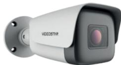
IP Camera 8 MP (4K): 3840x2160. Ottica motorizzata 2,7~13,5 mm. Supporta funzioni SMART. 4x IR LED array (Portata 75~80 m). 1 Ingresso e 1 Uscita Audio. Microfono integrato, 2 Ingressi e 1 Uscita Allarme. Slot per microSD card fino a 512 GB. Alimentazione 12 Vdc, PoE 802.3af. Grado di protezione IP67. Housing metallico B52.
