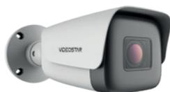
IP Camera 5 MP: 2880x1620. Ottica motorizzata 2,7~13,5 mm. Supporta funzioni SMART. 4x IR LED array (Portata 75~80 m). 1 Ingresso e 1 Uscita Audio. Microfono e Speaker integrati, 1 Ingresso e 1 Uscita Allarme. Slot per microSD card fino a 512 GB. Alimentazione 12 Vdc, PoE 802.3af. Grado di protezione IP67. Housing metallico B52.
