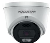
IP Camera 8 MP (4K): 3840x2160. Ottica fissa da 2,8 mm. Supporta funzioni SMART. 2x IR LED array (Portata 45~50 m)+2x LED bianchi (Portata 10~15 m). 1 Ingresso e 1 Uscita Audio. Microfono e Speaker integrati, 1 Ingresso e 1 Uscita Allarme. Slot per microSD card fino a 512 GB. Alimentazione 12 Vdc, PoE 802.3af. Grado di protezione IP66. Housing metallico D39.
