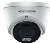
IP Camera 5 MP: 2880x1620. Ottica fissa da 2,8 mm. Supporta funzioni SMART. 2x IR LED array (Portata 25~30 m)+2x LED bianchi (Portata 10~15 m). 1 Ingresso e 1 Uscita Audio. Microfono e Speaker integrati, 1 Ingresso e 1 Uscita Allarme. Slot per microSD card fino a 512 GB. Alimentazione 12 Vdc, PoE 802.3af. Grado di protezione IP66. Housing metallico D39.
