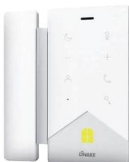
Monitor audio interno SIP per montaggio a parete. Sistema Linux. Handset e vivavoce integrati. Touch capacitivo. Porta Ethernet 10/100 Mbps. Wi-Fi 2,4 GHz integrato. 1 Uscita alimentazione 12V-100mA e 8 Ingressi. Alimentazione 12 Vdc - 2A e PoE 802.3af (Alimentatore non in dotazione). Per interno. Housing plastico.
