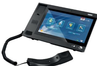
Master station SIP per montaggio a parete o a tavolo. Sistema Android 10. Monitor TFT LCD (1024 x 600) touch capacitivo da 10,1". Microfono e Speaker integrati. Porta Ethernet 10/100 Mbps. 8 Ingressi. 1 slot per microSD. Alimentazione 12 Vdc - 2A e PoE 802.3af (Alimentatore non in dotazione). Per interno. Housing plastico.
