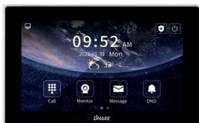
Monitor audio/video interno SIP per montaggio a parete o a tavolo. Sistema Android 10. Monitor IPS LCD (1280 x 800) touch capacitivo da 10,1". Microfono e Speaker integrati. Porta Ethernet 10/100 Mbps. 1 Ingresso Relay + 1 da 12V - 100mA. 8 Ingressi. 1 slot per microSD. Alimentazione 12 Vdc - 2A e PoE 802.3af (Alimentatore non in dotazione). Per interno. Housing plastico.
