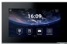
Monitor audio/video interno SIP per montaggio a parete o a tavolo. Sistema Android 10. Monitor TFT LCD (1024 x 600) touch capacitivo da 7". Microfono e Speaker integrati. Porta Ethernet 10/100 Mbps. 1 Uscita alimentazione 12V-100mA e 8 Ingressi. 1 slot per microSD. Alimentazione 12 Vdc - 2A e PoE 802.3af (Alimentatore non in dotazione). Per interno. Housing plastico.
