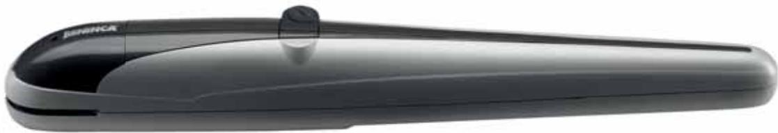
Motoriduttore affidabile e rapido da installare, grazie ai 2 fermi meccanici regolabili in apertura e chiusura. Disponibile nelle versioni 230 Vac e 24 Vdc. Vite rullata a sezione sferica Ø 20 mm. Sblocco dall'alto di facile accesso.
