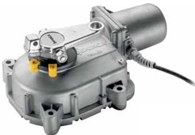
Motoriduttore elettromeccanico irreversibile disponibile nelle versioni 230 Vac e 24 Vdc, con possibilità di apertura a 180°. Meccanica totalmente in metallo e arresto meccanico incorporato.
