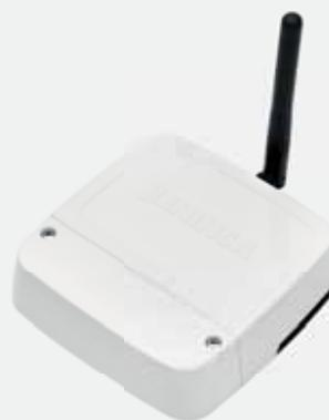
Modulo ricetrasmittitore 868 MHz per il controllo da remoto di automazioni o dispositivi. Da installare a bordo delle centrali, degli impianti da gestire o esternamente a parete grazie al pratico coperchio copri-morsetti. Dotato di due ingressi con comando libero da tensione e due uscite a relè 250V 5A (carico resistivo), accetta alimentazione 12 o 24 Vac/dc. Dotato di antenna stilo 868 MHz, lunghezza 9 cm con LED RGB per diagnostica e programmazione.
