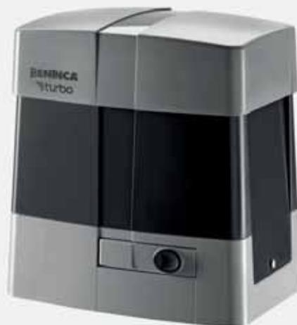
Nuovo motore per cancelli scorrevoli fino a 1200 kg a 24 Vdc dotato di alimentatore switching 115/230 Vac. Centrale di comando integrata posta nella parte superiore del motore e dotata di encoder virtuale che permette una gestione ottimale dei rallentamenti con possibilità di tracciarne il tragitto (STC System).
