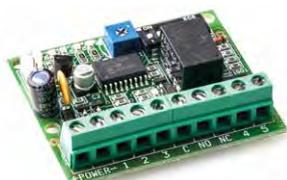
**MCV** - Circuito multifunzione 12 Vcc per contatti tapparelle e magnetici (fino a 4 totali), un'uscita relè da 1 A e un'uscita optoisolata. Dimensioni: 55x45x18 mm (HxLxP) - peso: 25 gr.
