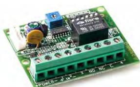
**MTT** - Circuito multifunzione 12 Vcc per ritardare o temporizzare 1 ingresso da 1 mA - un'uscita relè da 1 A - un'uscita O.C. Dimensioni: 55x45x18 mm (HxLxP) - peso: 23 gr.
