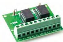
**RN 12/24** - Scheda 12/24 Vcc per open collector con due ingressi e due uscite a relè. Due ingressi da 25 mA e due uscite a due relè da 1 A. LED di segnalazione. Dimensioni (HxLxP) 55x45x17 mm - peso: 30 gr.
