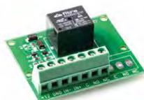
**RA/T** - Scheda 12 Vcc a basso assorbimento per open collector con uscita a relè. Un ingresso da 1 mA e un'uscita relè da 3 A. LED di segnalazione. Dimensioni (HxLxP) 55x45x18 mm - peso: 26 gr.
