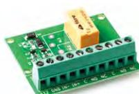
**RA/2S** - Scheda 12 Vcc a basso assorbimento per open collector con due uscite isolate. Un ingresso da 1 mA e due uscite relè da 1 A. LED di segnalazione. Dimensioni (HxLxP) 55x45x17 mm - peso: 26 gr.
