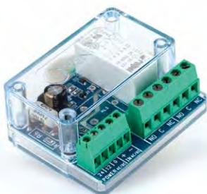
**FULL RELAY** - Scheda d'interfaccia con alimentazione 12/24 Vcc / Vca, consumo massimo 40 mA @ 24 Vcc ed ingresso optoisolato 3 - 30 Vcc / Vca massimo 10 mA. Uscita a doppio scambio con contatto pulito da massimo 8 A 250 Vcc / Vca. 2 uscite da 8 Ah o 1 uscita da 16 Ah. Dimensioni (HxLxP) 60x48x26 mm - peso: 48 gr.
