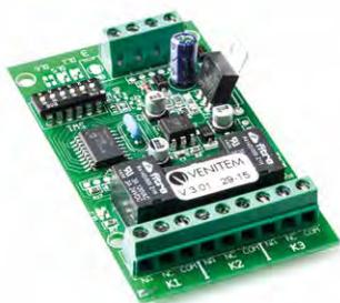
**CTT/R** - Circuito di segnalazione mancanza rete, ritorno rete e anomalia batteria - ingresso optoisolato - tre relè di uscita da 1 A. Dimensioni: 85x50x20 mm (HxLxP) - peso: 40 gr.
