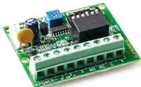
**MCX** - Circuito multifunzione 12 Vcc, 1 contatto tapparella, serranda, sensore inerziale, vibrazione - un ingresso da 1 mA - un'uscita relè da 1 A - un'uscita O.C. Dimensioni: 55x45x18 mm (HxLxP) - peso: 23 gr.
