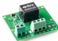
**RA** - Scheda 12 Vcc per open collector con uscita a relè. Un ingresso da 35 mA e un'uscita relè da 3 A. LED di segnalazione. Dimensioni (HxLxP) 55x45x18 mm - peso: 24 gr.
