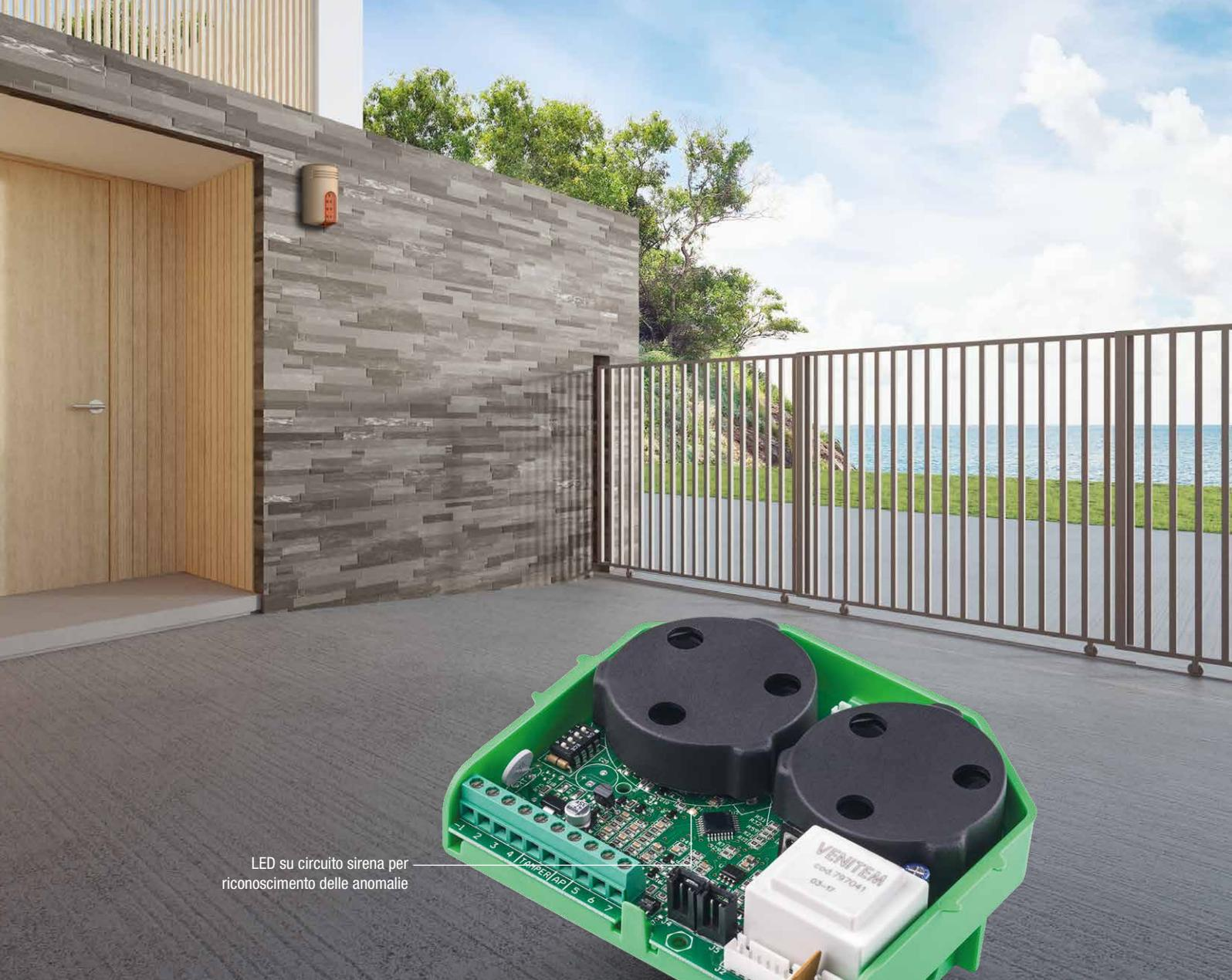
LED su circuito sirena per riconoscimento delle anomalie
