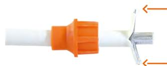
4 > Inserire il dielettrico nell'apertura quadrata dell'SPC fino a farlo fuoriuscire dal lato opposto; premendo le lame, ruotare l'SPC di + -90° per il taglio e la rimozione del dielettrico.
