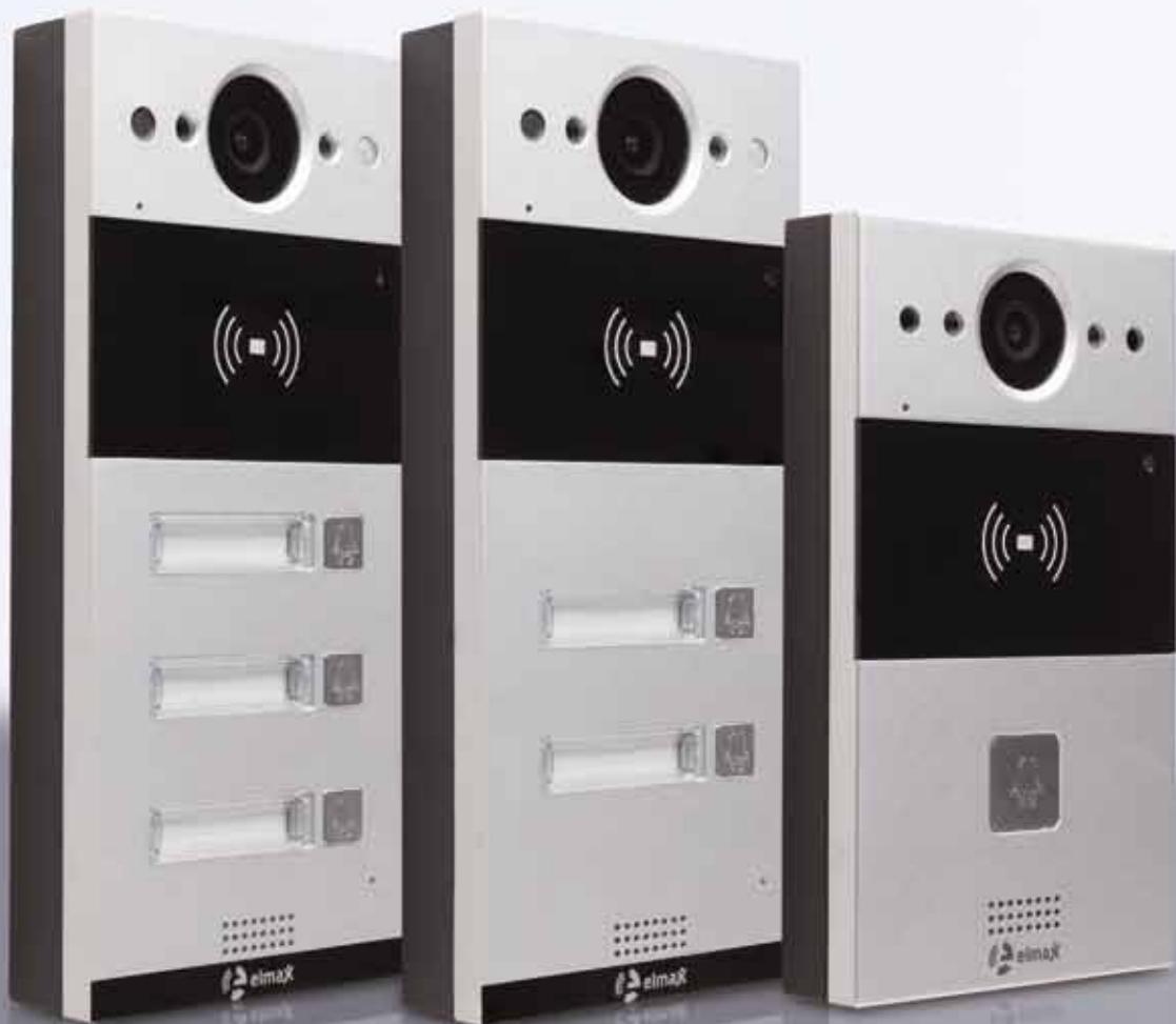
I videocitofoni sono dotati di corpo metallico antivandalo, con pulsante a filo e frontale in alluminio anodizzato. Dispongono di fotocamera da 2 Mpx grandangolare con apertura 110° in orizzontale e 58° in verticale. Il collegamento alla rete Ethernet avviene tramite una porta RJ45 PoE (IEEE802.3af, Power over Ethernet) che anche li alimenta. È dotato di comunicazione audio bidirezionale su reti IP con funzione Echo Cancel. È conforme allo standard SIP per una facile
