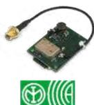
**Modulo GSM/GPRS dual-band linea One dotato di connettore per il collegamento di un'antenna esterna alle centrali per connessione alla rete cellulare GSM. Necessita di kit di antenna non in dotazione**
