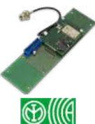
**Modulo opzionale GSM Dual Band. Necessita di antenna Serie GSMAC**
