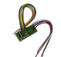
**Concentratore miniaturizzato a 2 ingressi cablati con connessioni pigtail**
