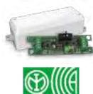
Ripetitore di linea seriale che ripete, rigenera e isola funzionalmente la linea seriale RS-485 ULTRABUS
