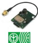
**Modulo GSM/GPRS dual-band dotato di connettore per il collegamento di un'antenna esterna alle centrali per connessione alla rete cellulare GSM. Necessita di kit di antenna non in dotazione**
