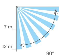
La zona di rilevazione ad infrarossi è identica alla zona di visibilità ottica (fotocamera)
