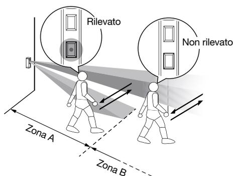
La portata della rilevazione è di 2 m o di 5 m (in funzione della posizione della lente inferiore). L'allarme scatta al passaggio dell'intruso nella Zona A.
