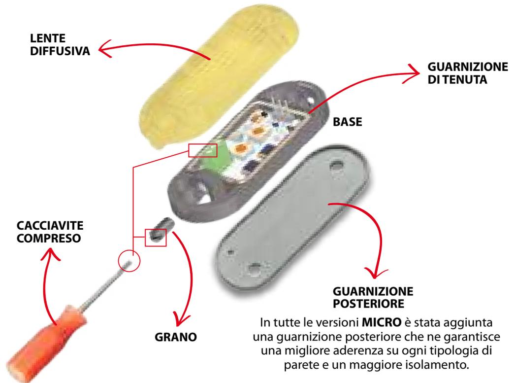
In tutte le versioni **MICRO** è stata aggiunta una guarnizione posteriore che ne garantisce una migliore aderenza su ogni tipologia di parete e un maggiore isolamento.
